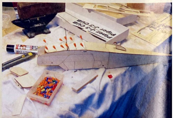
Die Verleimung der Rumpfunterfläche; im Vordergrund sieht man den im Text angesprochenen mitgelieferten Schleifklotz
